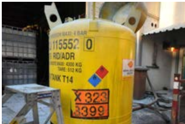
(Figuur 15) voorbeeld van een vat met een waterreactieve substantie; het waterreactieve aspect is herkenbaar aan de letter X op het oranje Kemmler-gevaarsbord Copyright 2012 van Salzi.at
