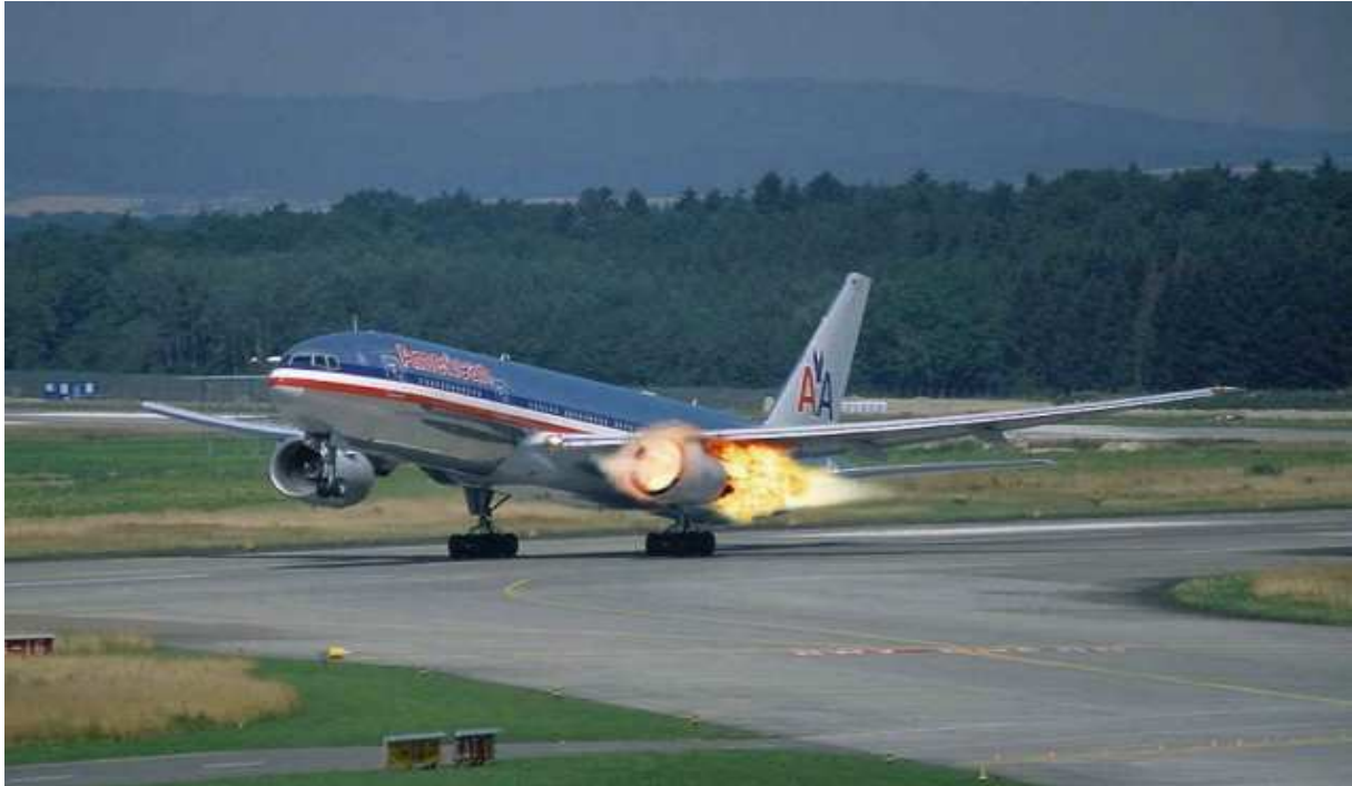
Fig. 3 Brand in de straalmotor van een Boeing 777-200 van American Airlines.
